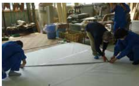
図2 原寸図に作図しているところ
