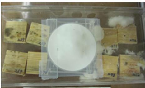
写真2 雨水散布による腐朽進行状況
