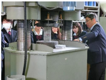
②円柱コンクリートが目前で炸裂
