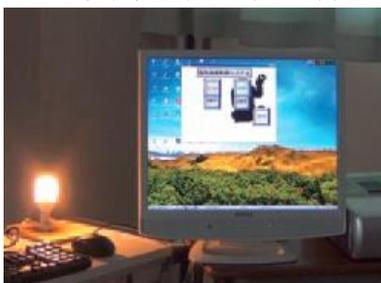
(写真左) 有線部門最優秀賞「電気機器制御システム」: パソコン上で自由に電気機器を制御できるシステム。このシステムの動作は kinect カメラで人を読みとり画面内の球体を操作しアイコンに触れることで電気機器のONとOFFを切り替えることができ、電気機器を3つ4つと増やしても問題なく簡単に操作できます。
