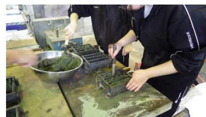
慣れた手つきでモルタルを型枠に流し込む
