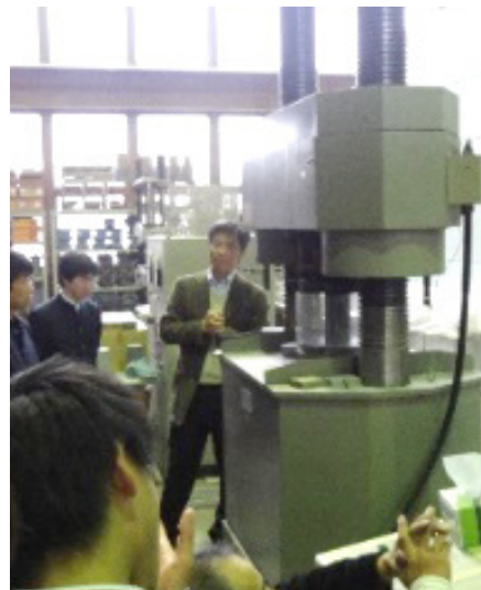
コンクリート強度の検査
