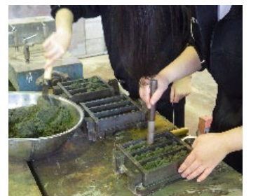
条件の異なるモルタルを型枠に流し込む
