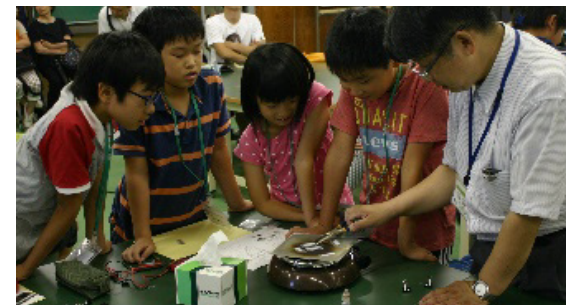
ガラス板に薬品を塗って太陽電池を作る
