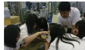
地震の時に起こる液状化現象の実験
